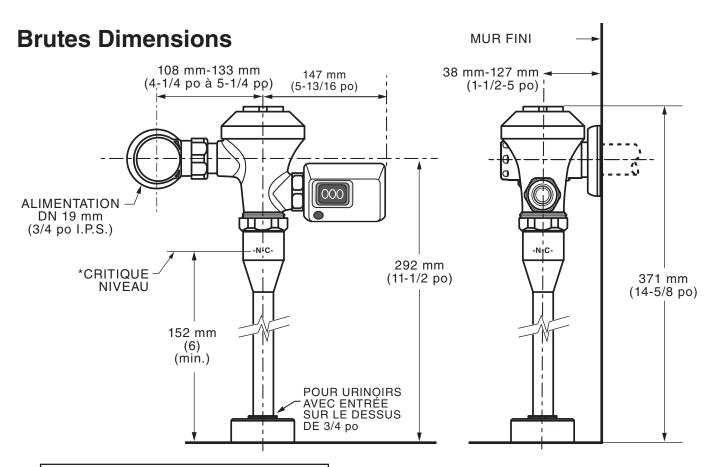
\*Remarque : Le niveau critique (-N-C-) d'un reniflard doit habituellement être au moins à 6 po (152 mm) au-dessus de l'appareil. Consultez les codes pour plus de détails.
